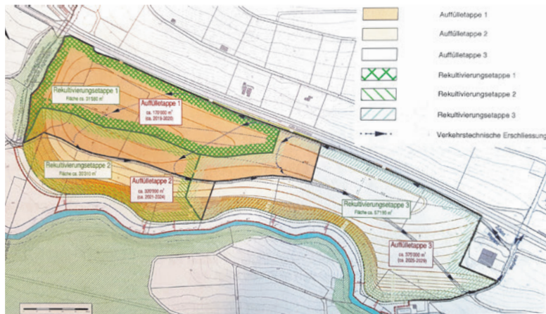
Der Plan zeigt die künftige Ausdehnung der Aushubdeponie «Buchselhalde» und die geplanten Auffülltabletten.
